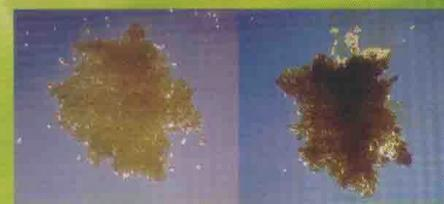
Surfactant yang diformulasikan secara efektif mampu membersihkan resin dari kotoran-kotoran yang menutupi permukaan sehingga mengurangi kemampuan penyerapan resin. Mampu melepaskan pengotor-pengotor dan mendispersikan nya sehingga mudah terbawa saat dilakukan flushing dan backwash. Mampu memperbaiki kembali kemampuan penyerapan dan memperpanjang umur resin.
